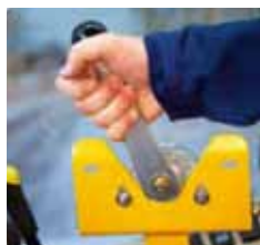
Commande de l'ouverture par télé flexible
