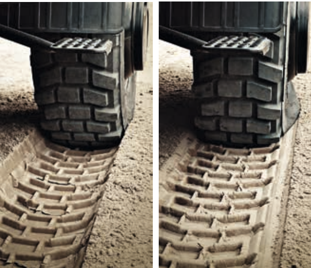
Grâce au principe de la monte pneumatique simple, les roues arrière suivent les traces des roues avant pour améliorer la motricité tout en protégeant le sol.
