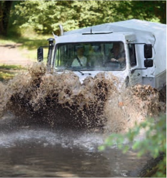
Toujours au sec : grâce à sa garde au sol importante, à son long tuyau d'aspiration et ses organes protégés, l'Unimog est capable de franchir des gués jusqu'à 80 cm (120 cm en option)
