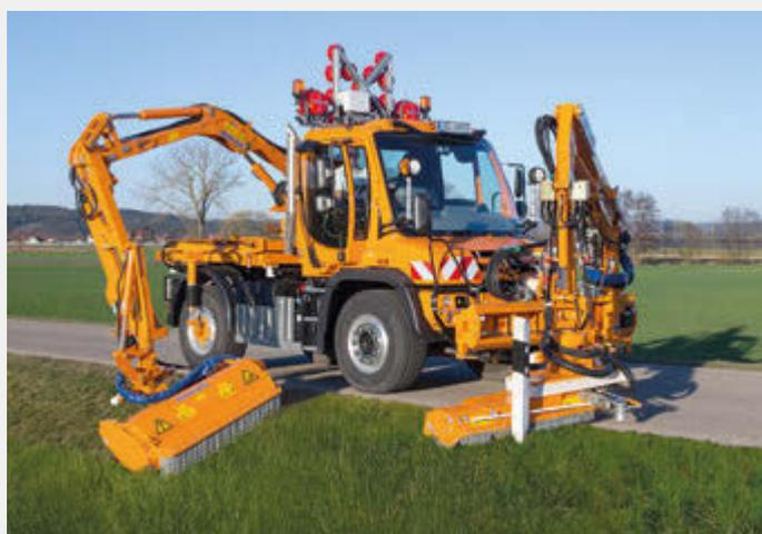
Faucheuses-débroussailleuses avant pour une utilisation polyvalente
