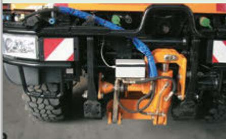
Verrouillage du pont avant du véhicule porteur empêchant la torsion unilatérale due aux mouvements de l'équipement lors du fauchage. Le blocage de suspension est activé depuis la cabine du véhicule.
