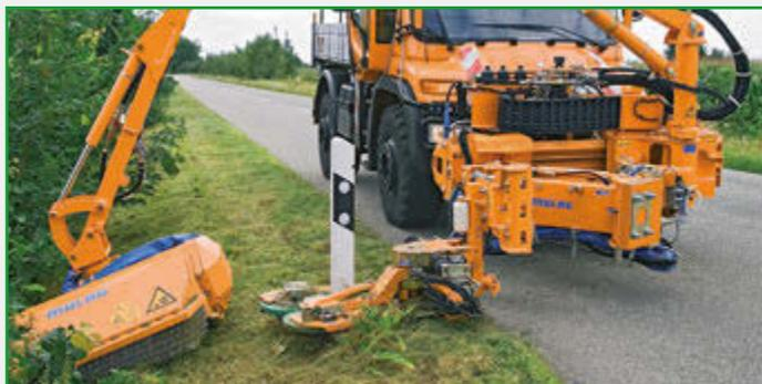
Faucheuse contournante en montage alterné sur MKM 700
