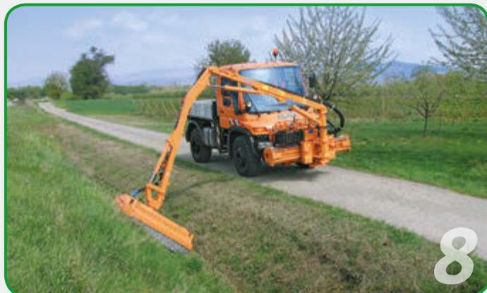
Nos faucheuses avant permettent une utilisation polyvalente jusqu'à 7,4 m de portée.
