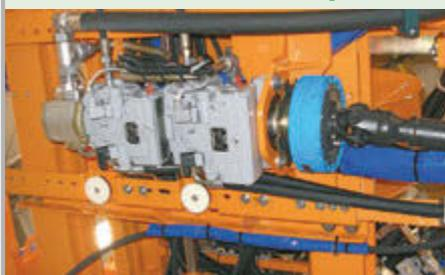
Les faucheuses arrière peuvent être entraînées par prise de force sur moteur Code N05. Ainsi, l'hydraulique de la faucheuse est complètement indépendante du véhicule.
