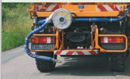
Montée dans les ferrures D50, elle permet de nettoyer efficacement la chaussée. Les salissures sont soufflées sur le bord de la route ou dans la banquette.
