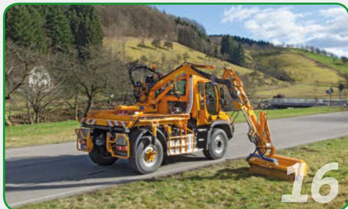
Avec les faucheuses arrière, vous exploitez l'Unimog au maximum et atteignez des portées jusqu'à 8,7 m.
