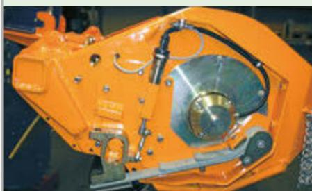
Réglage automatique de la pression d'appui au sol de la tête de coupe. Des capteurs informent le système sur la nature du terrain. Celui-ci commande les fonctions de flèche de façon indépendante.
