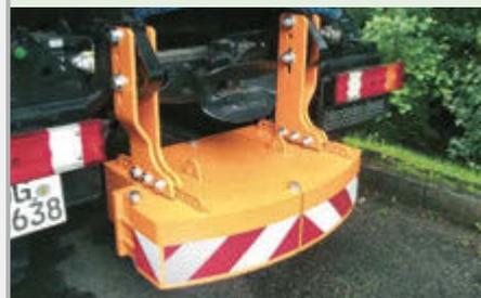
Ce système modulaire est placé dans les ferrures D50 et permet l'obtention – par l'ajout de plaques – d'un contrepoids jusqu'à 1400 kg.
