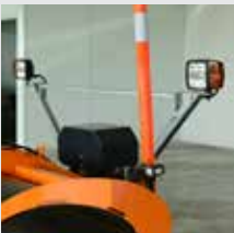
Repport de signalisation (Support de feux en galva + feux de route, de croisement et clignotants).
