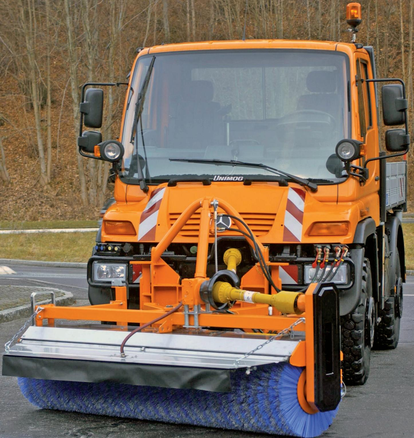
Les balayeuses portées de la série VKS sont conçues pour un montage à l'avant ou à l'arrière sur véhicules porteurs moyens et lourds. Elles interviennent pour le nettoyage de gros déchets sur des grandes surfaces.
