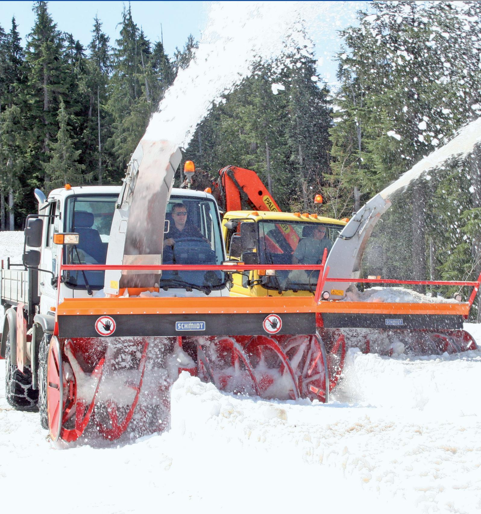
La série des turbo-fraises à neige robustes FS est conçue pour un montage sur véhicules porteurs Unimog et pour les interventions difficiles de déneigement dans les communes. Elle a été développée pour le déneigement performant par fraisage frontal de fortes hauteurs de neige dure et glacée. Même une élimination de bourrelets de neige créés par un déneigement à la lame est possible.
