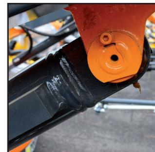
Axes de gros diamètre montés sur bague Teflon Arrêt d'axe.
