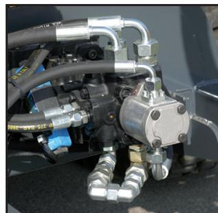
Pompe et moteur à pistons, corps acier
