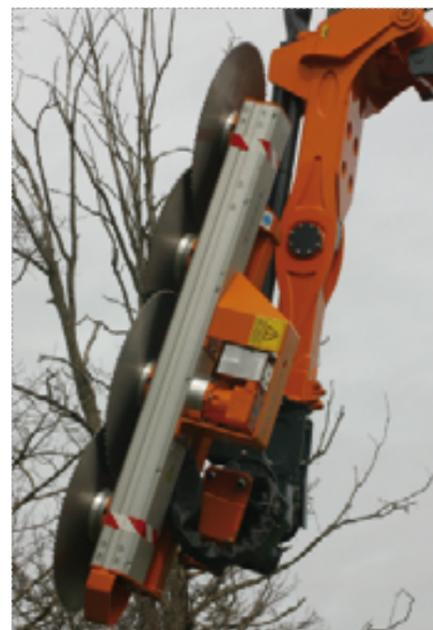
L.E.M. lamiers d'élagage modulaires. 2 ou 3 lames Ø 600, 650 ou 700 mm. Largeur de coupe de 1,08 à 1,66 m. Possibilité de montage de plateaux doubles à couteaux mobiles. Corps en profilé d'alliage léger très rigide garanti à vie. Graissage centralisé sur le module principal.
