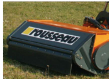
Groupe de broyage 1,20 m acier, profilé et renforcé. Entraînement indirect du rotor par courroie crantée fibre de verre. Au choix profil de coupe « fauchage » ou « débroussaillage ». Rouleau palpeur Ø 140 mm démontable (Enduro en option).
