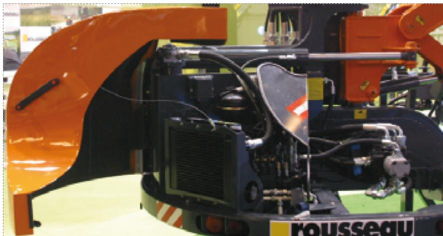
Pompe et moteur à pistons, corps acier. Connectique étanche. Parfaite accessibilité de la plateforme technique.
