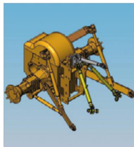
La débroussailleuse KASTOR s'attelle sur le relevage arrière du porteur avec barres de rigidification. En option, nous vous proposons :
