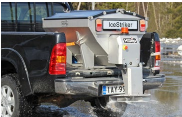
Largeur d'épandage de jusqu'à 8 mètres
