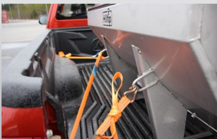
Crochets de fixation de l'épandeur au véhicule
