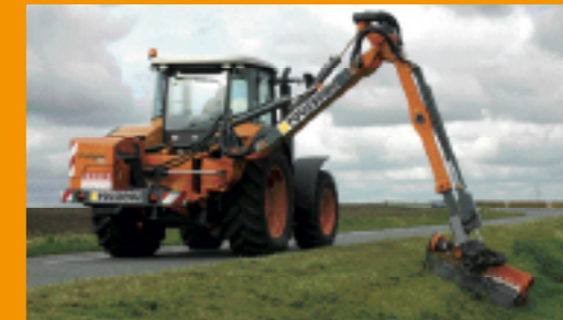
Passage sous flèche
