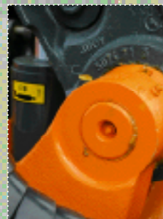
Axe plein Ø 60 mm graissé par le centre
