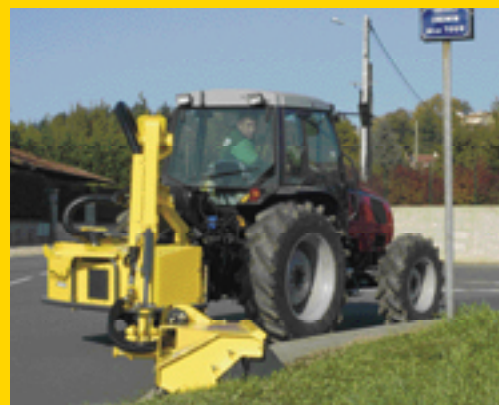
Balayage 115°, chantiers difficiles et contournement d'obstacles Sécurité hydraulique
