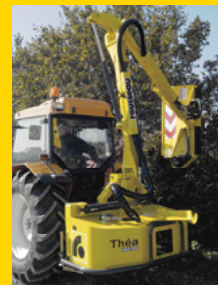
Cinématique avec pivot central pour des chantiers au plus près du tracteur
