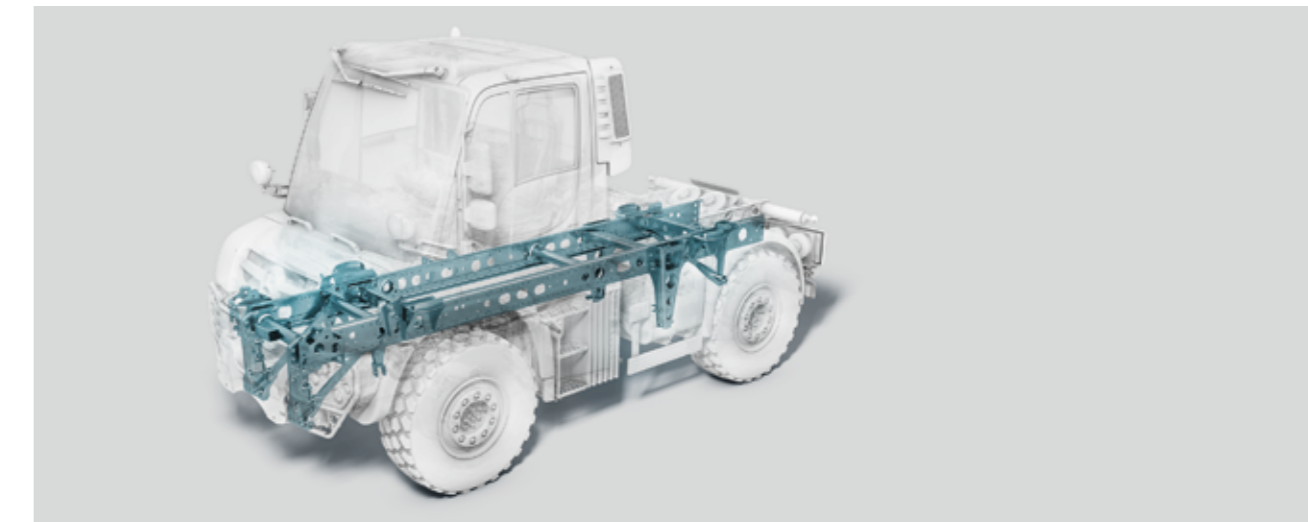
Quatre emplacements de montage et de fixation : le porte-outils Unimog est l'un des engins de travail les plus productifs qui soient. Grâce à ses interfaces normalisées, il peut être couplé à d'innombrables outils pour couvrir plus de 1 000 applications. Outre une plaque de montage avant, des points de liaison sur le cadre et des ferrures de montage sur les côtés et à l'arrière, il dispose de rotules au niveau du faux-châssis du plateau pour faciliter les transformations.
