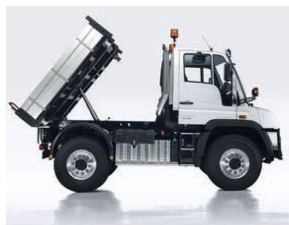
Le vérin de basculement autonome permet d'actionner la benne ou la remorque sans utiliser l'hydraulique de travail.
