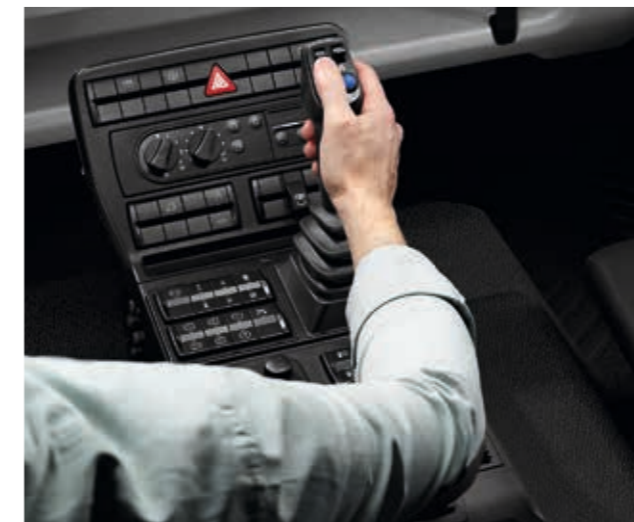
Pilotage intuitif et simplifié des outils avec le nouveau joystick multifonctions amovible.
