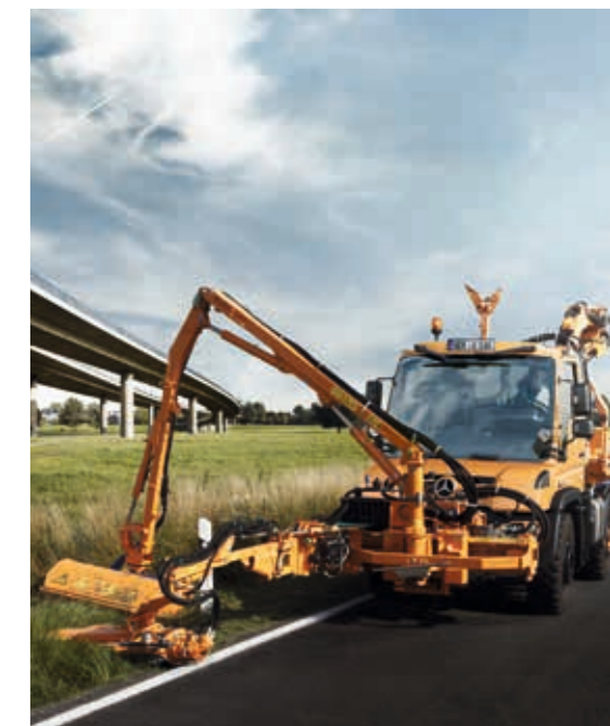
Grâce à ses systèmes hydrauliques, l'Unimog peut être équipé de trois faucheuses pour exécuter trois opérations en un passage.
