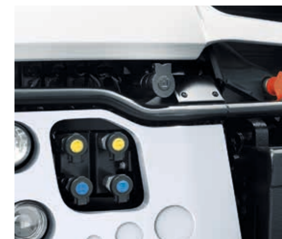
Placés à l'avant et à l'arrière du véhicule, les raccords des circuits hydrauliques (jusqu'à quatre) sont parfaitement protégés.
