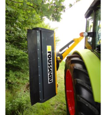
La cinématique du bras avancé de 62 cm, soit 1.31 m entre axe flèche et axe rotor, offre visibilité et confort de travail.
