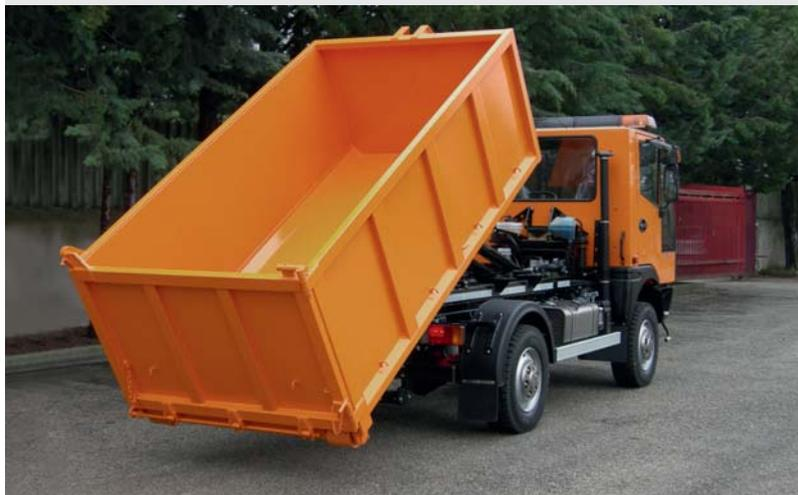
*MT740 avec système de levage à crochet*
