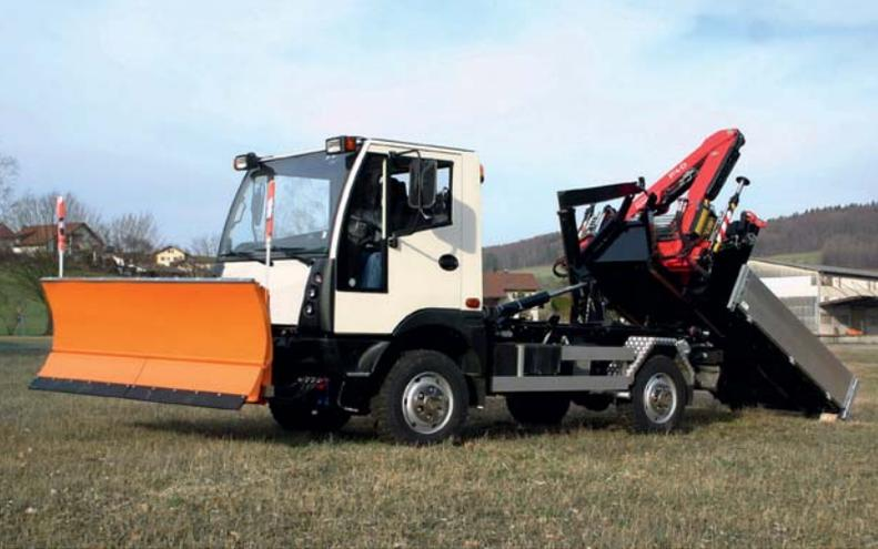
*MT740 avec lame de déneigement et système de levage à crochet*
